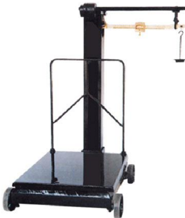
ภาพที่ 2 เครื่องชั่งระบบคานเลื่อน (สำนักงานกลางชั่ง วัด ตวง, 2550, หน้า 92)
