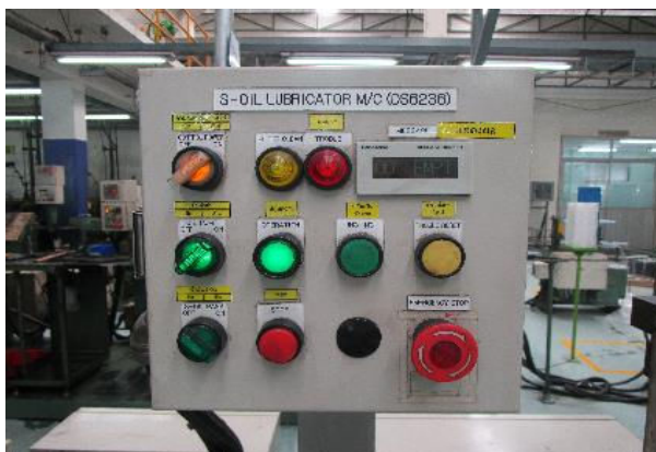
ภาพที่ 4-32 ปุ่มกดเครื่องจักร (หลังการปรับปรุง)
