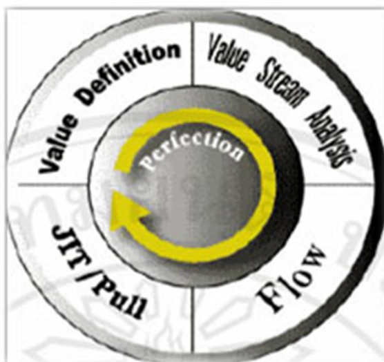
ภาพที่ 2-2 หลักการพื้นฐานของการผลิตแบบลีน (ประกาศิต พวงเงิน และคณะ, 2555)
