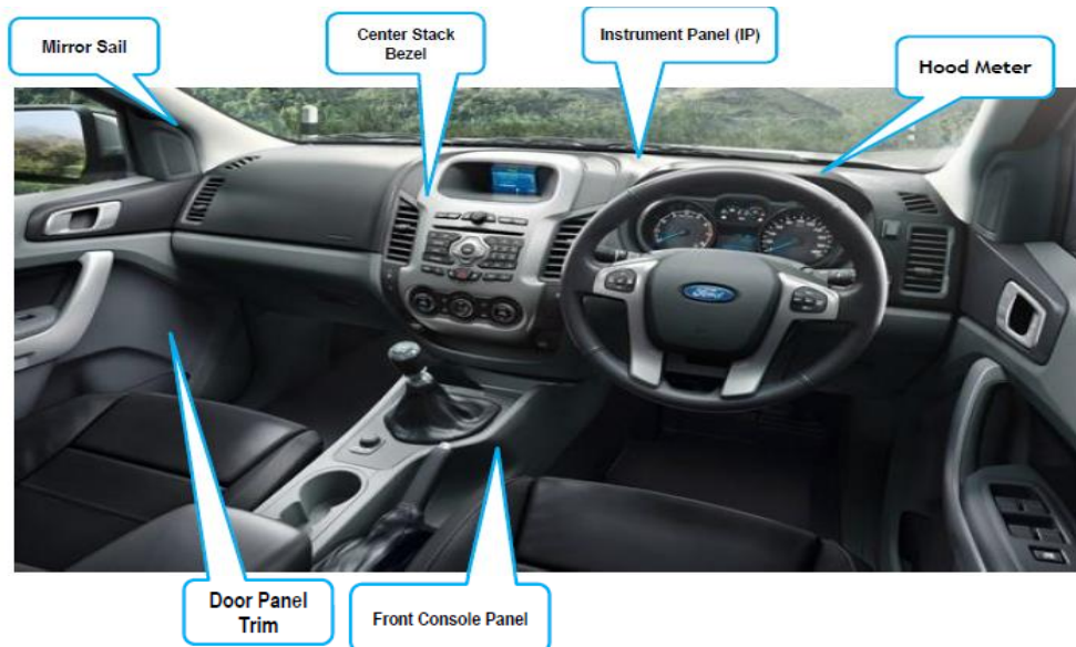
ภาพที่ 2-2 ชิ้นส่วนภายในรถยนต์ (Interior parts) ของบริษัท ABC จำกัด ที่ใช้สำหรับประกอบรถกระบะของบริษัท ออโต้อัลลายแอนซ์ (ประเทศไทย) จำกัด (AAT)
