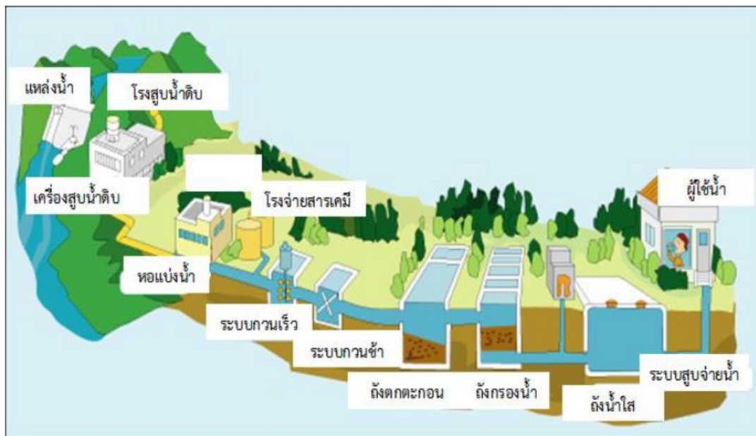
ภาพที่ 6 การบริหารจัดการ WSP ตั้งแต่ต้นน้ำจนถึงบ้านผู้ใช้น้ำ (การประชาสัมพันธ์, 2558, หน้า 1)
