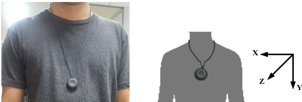
ภาพที่ 3-14 การสวมใส่อุปกรณ์เฝ้าติดตามตัวสำหรับผู้สูงอายุ
