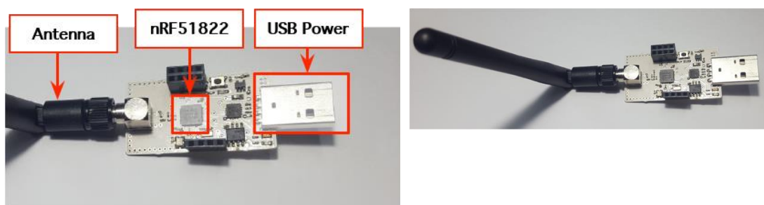
ภาพที่ 3-5 บอร์ดจริงของอุปกรณ์ทวนสัญญาณ (Repeater)
