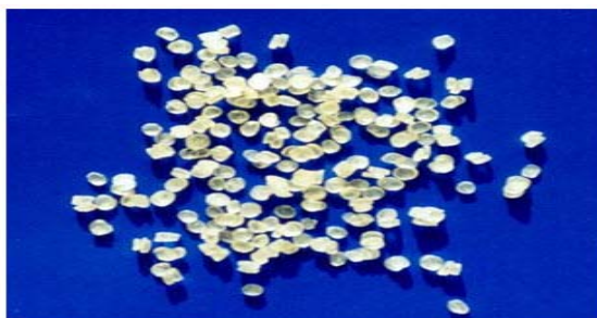
ภาพที่ 5 เม็ดพลาสติกที่ผลิตจากเทอร์โมพลาสติกสตาร์ช
