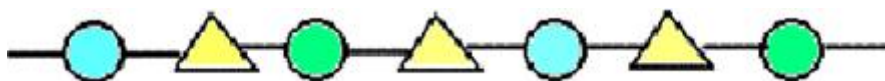
รูปที่ 2 พอลิเมอร์ที่ประกอบด้วยมอนอเมอร์หลายชนิด
