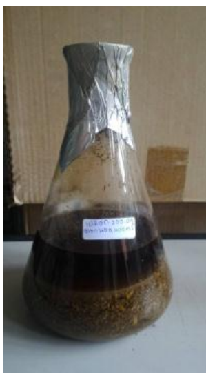
ภาพที่ ข-6 การสกัดสารจากเปลือกลำต้นด้วยเมทานอล
