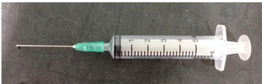
ภาพที่ 3-2 เข็มฉีดยาสำหรับหยดสารตัวอย่างของเหลว
