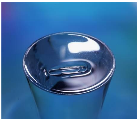
ภาพที่ 2-4 ลวดเสียบกระดาษวางบนผิวน้ำ
