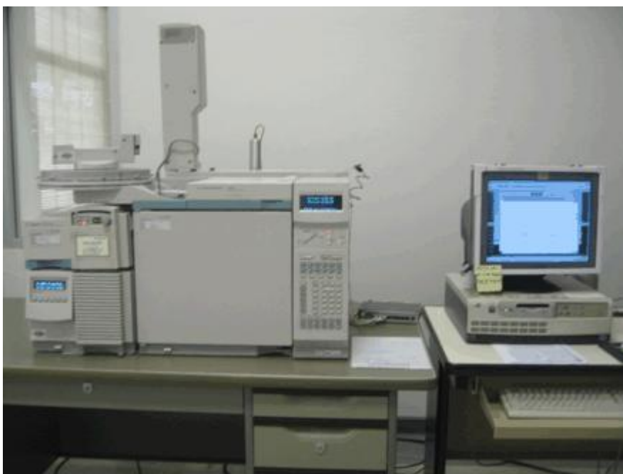
ภาพภาคผนวก ข-1 เครื่อง Gas chromatography-mass spectrometer (GC-MS)
