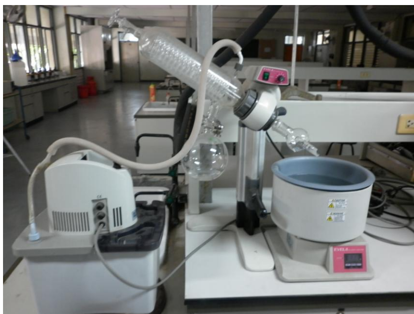
ภาพภาคผนวก ข-2 เครื่องกลั่นระเหยสารแบบหมุน (Rotary evaporator)
