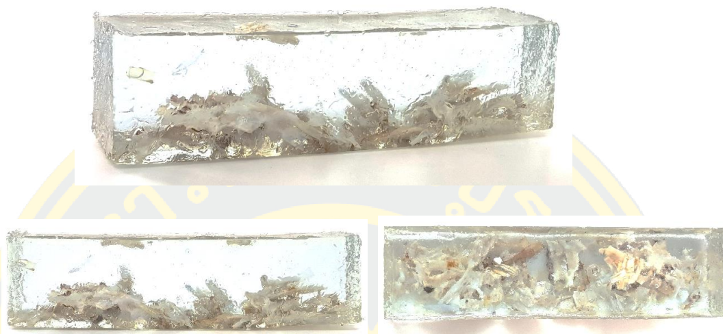
ภาพที่ 65 การขึ้นรูปเศษขวดน้ำพลาสติกที่เหลือจากการหลอมครั้งแรกด้วยการหล่อเรซิน
