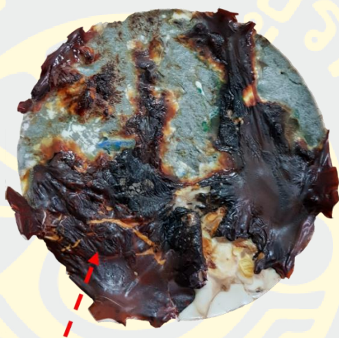
ภาพที่ 54 การทดลองอุณหภูมิความร้อนในการหลอมพลาสติกชนิด HDPE ที่ 250 องศาเซลเซียส
