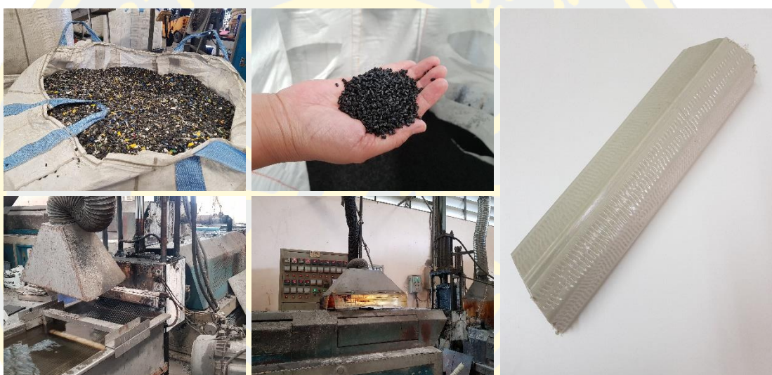
ภาพที่ 23 กระบวนการหลอมพลาสติกกรีไซเคิลทางอุตสาหกรรม
