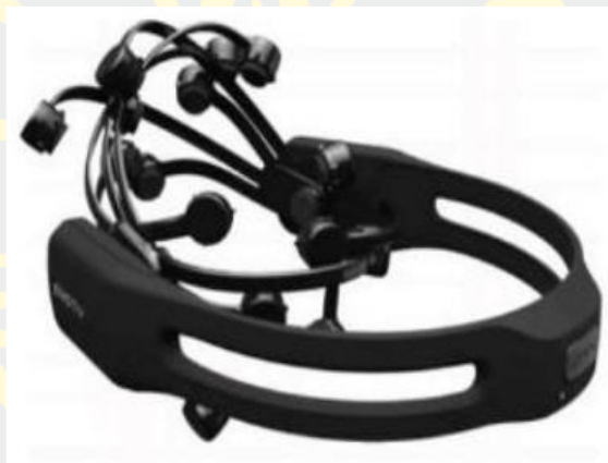
ภาพที่ 19 อุปกรณ์ตรวจวัดคลื่นสมอง Emotiv รุ่น EPOC
