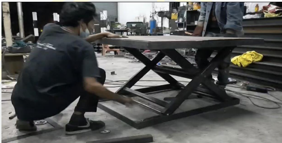
ภาพที่ 18 การสร้างอุปกรณ์ช่วยที่สามารถปรับระดับความสูงของการวางพาเลท
