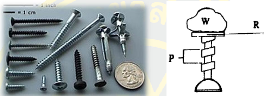
รูปที่ 9 สกรูมีลักษณะคล้ายบันไดเวียนวนรอบแกนอันหนึ่ง
