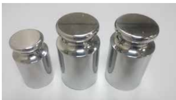
รูปที่ 2 วัตถุที่มีน้ำหนักคงที่ มีมาตรฐานตรวจสอบขนาด
