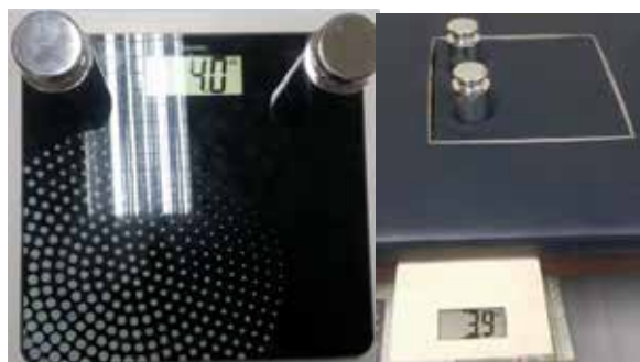
รูปที่ 3 วางวัตถุที่มีน้ำหนักคงที่มีมาตรฐานลงบนเครื่องชั่งน้ำหนักที่มีมาตรฐาน
