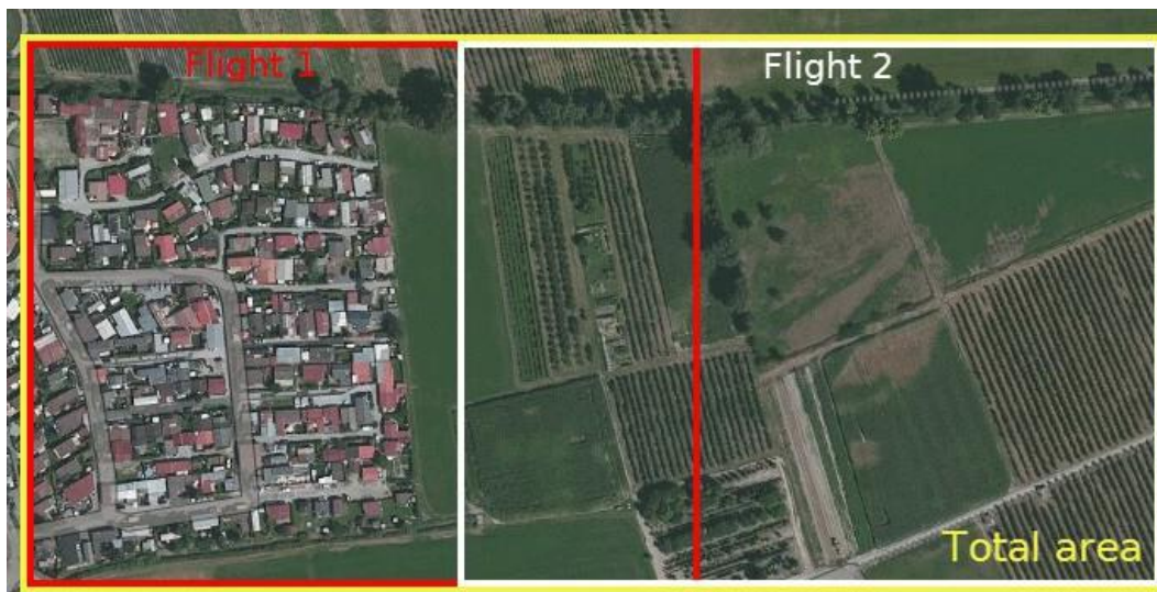
ภาพที่ 12 images acquisition plan ที่แนะนำสำหรับ two flights.
