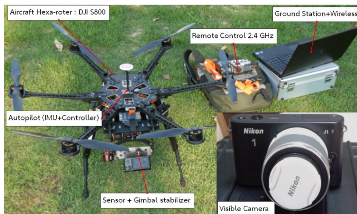
ภาพที่ 1-1 องค์ประกอบของระบบหุ่นยนต์อากาศยานขนาดเล็ก ที่มา Charoenjit, K., Pattanakiat, S.
