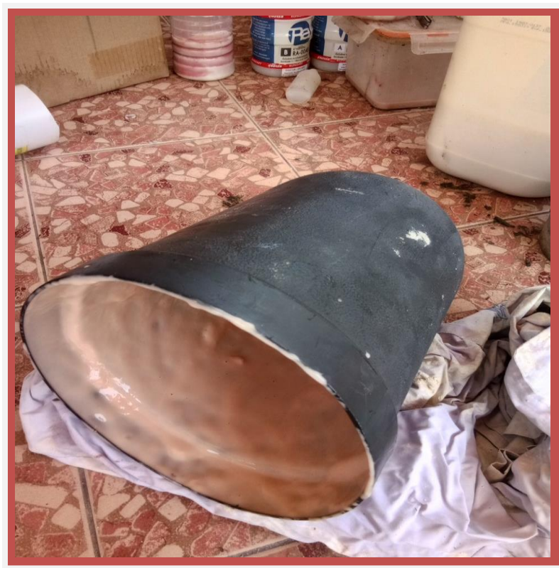
ภาพที่ 12 ถังสำหรับหล่อบรอกด้วยวิธีการกลึงแม่พิมพ์
