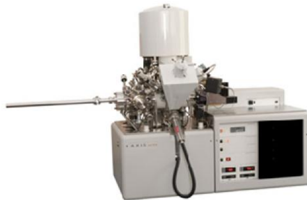
รูปที่ 2.27 เครื่อง X-ray Photoelectron Spectroscopy (CNSI LAB MANAGEMENT SYSTEM, 2016)
