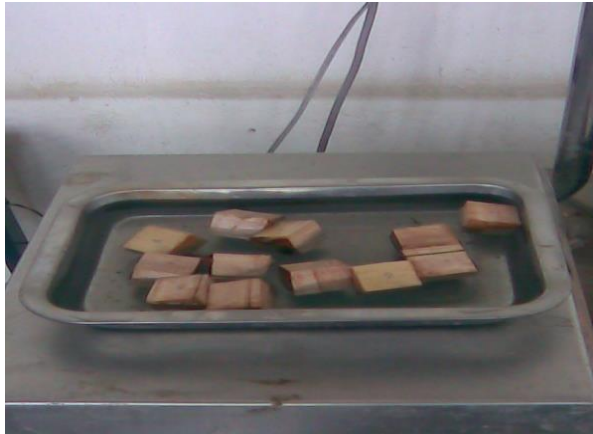
รูปที่ 4.7 การแช่น้ำของไม้ในการดูดซับน้ำ
