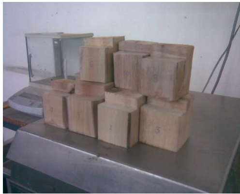
รูปที่ 4.48 ขนาดของไม้ในการทดสอบการเดือนขนานเสี้ยน
