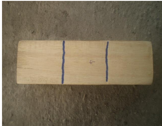
รูปที่ 4.11 การเสียรูปหลังจากทดสอบแรงอัดตั้งฉากเส้น
