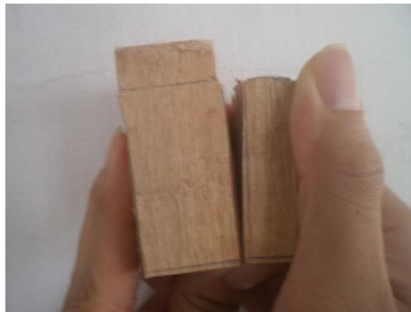
รูปที่ 4.52 การเสียรูปหลังจากทดสอบการเหือนของไม้
