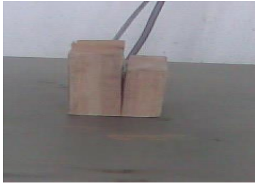
รูปที่ 4.51 การเสียรูปหลังจากทดสอบการเหือนของไม้
