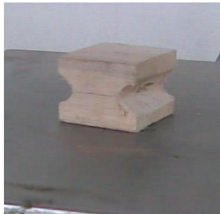
รูปที่ 4.39 ขนาดของไม้ในการทดสอบการดึงตั้งฉากเส้น
