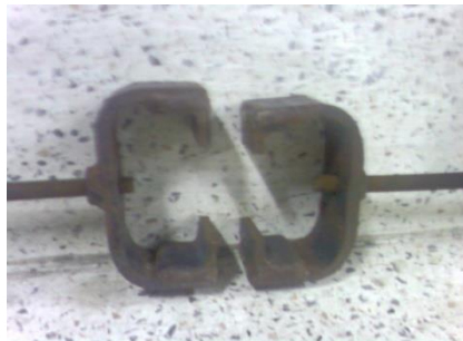
รูปที่ 3.5 ตัวอย่างไม้ทดสอบกำลังต้านทานแรงเฉือน
