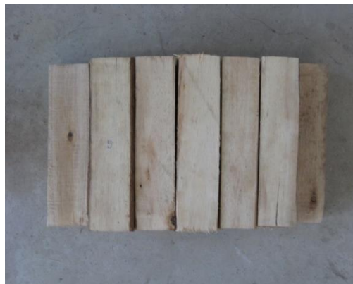
รูปที่ 4.23 ขนาดของไม้ในการทดสอบแรงอัดขนานเสี้ยน
