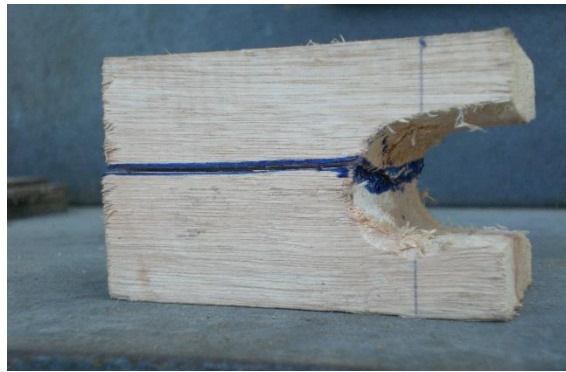
รูปที่ 4.46 การเสียรูปหลังการทดสอบการฉีกแตกของไม้
