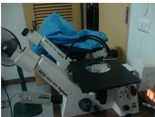
รูปที่ 3.6 กล้องจุลทรรศน์แสง รุ่น Axiovert 25 ผู้ผลิต Carl Zeiss
