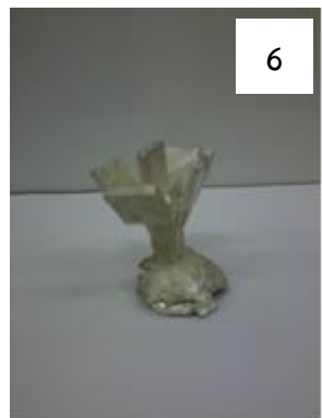
รูปที่ 4.1 ชิ้นงานหล่อกิ่งของแข็งที่ระยะเท 20 เซนติเมตรโดยมีมุม 1) 30^\circ 2) 45^\circ และ 3) 60^\circ และ ระยะเท 25 เซนติเมตรโดยมีมุม 4) 30^\circ 5) 45^\circ และ 6) 60^\circ
