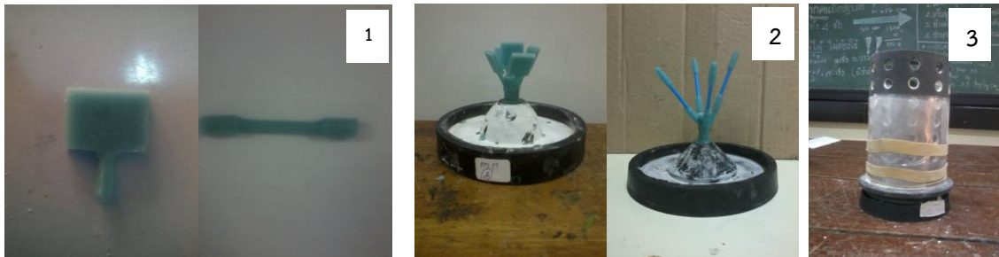
รูปที่ 3.1 การเตรียมชิ้นงาน 1) ชิ้นงาน 2) ต้นเทียน และ 3) กระบอกล่อเหล็กมาครอบต้นเทียน
