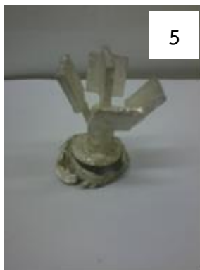
รูปที่ 4.1 ชิ้นงานหล่อกิ่งของแข็งที่ระยะเท 20 เซนติเมตรโดยมีมุม 1) 30^\circ 2) 45^\circ และ 3) 60^\circ และ ระยะเท 25 เซนติเมตรโดยมีมุม 4) 30^\circ 5) 45^\circ และ 6) 60^\circ
