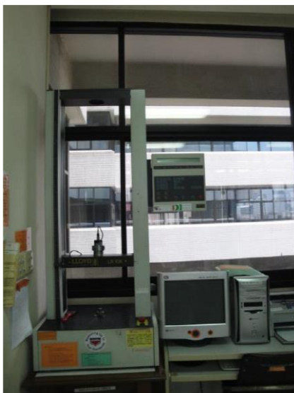
รูปที่ 3.9 เครื่องทดสอบแรงดึง รุ่น LR10K ผู้ผลิต LLOYD Instruments
