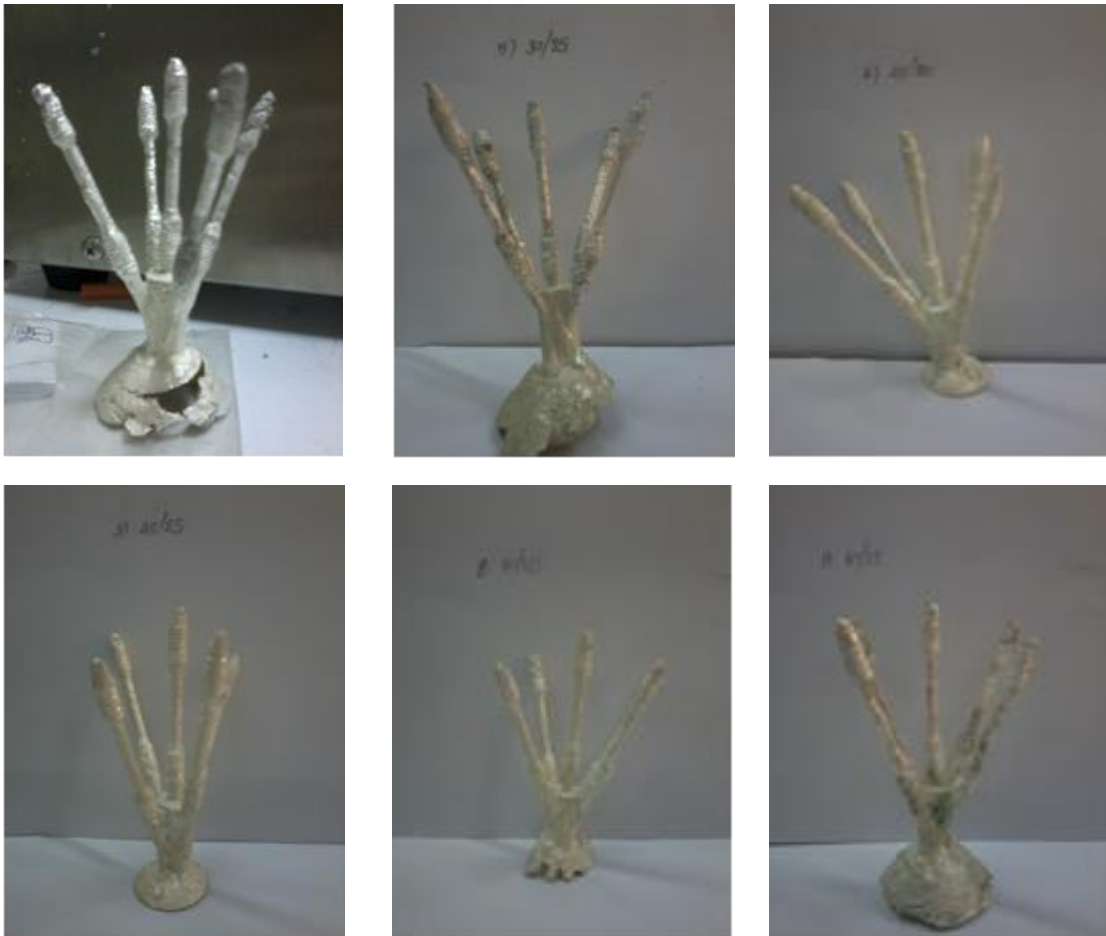
รูปที่ 4.2 ชิ้นงานหล่อกิ่งของแข็งสำหรับทดสอบแรงดึง หล่อที่ระยะเท 20 เซนติเมตรโดยมีมุม 1) 30° 2) 45° และ 3) 60° และ ระยะเท 25 เซนติเมตรโดยมีมุม 4) 30° 5) 45° และ 6) 60°
