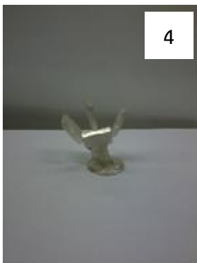
รูปที่ 4.1 ชิ้นงานหล่อกิ่งของแข็งที่ระยะเท 20 เซนติเมตรโดยมีมุม 1) 30^\circ 2) 45^\circ และ 3) 60^\circ และ ระยะเท 25 เซนติเมตรโดยมีมุม 4) 30^\circ 5) 45^\circ และ 6) 60^\circ
