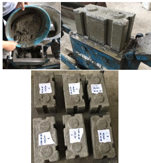
ภาพที่ 1 การเตรียมตัวอย่างจีโอพอลิเมอร์คอนกรีตบล็อก
