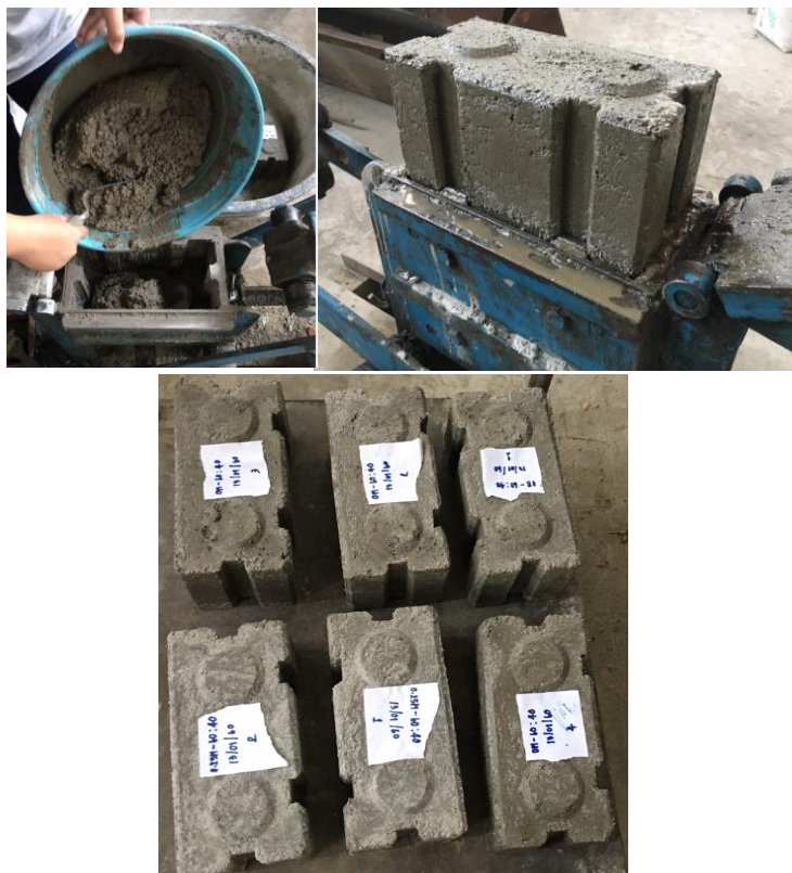
รูปที่ 3.2 การเตรียมตัวอย่างอีพอกซีคอนกรีตบล็อก
