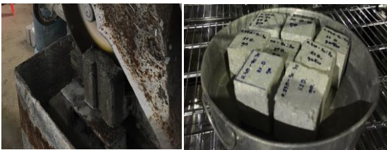
ภาพที่ 2 การตัดตัวอย่างจีโอพอลิเมอร์คอนกรีตบล็อกสำหรับ ทดสอบกำลังอัด
