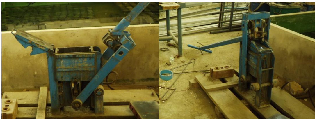
ก) เครื่องอัดบดลึอกคอนกรีตชนิดซินวา-แรม (Cinva-ram)
