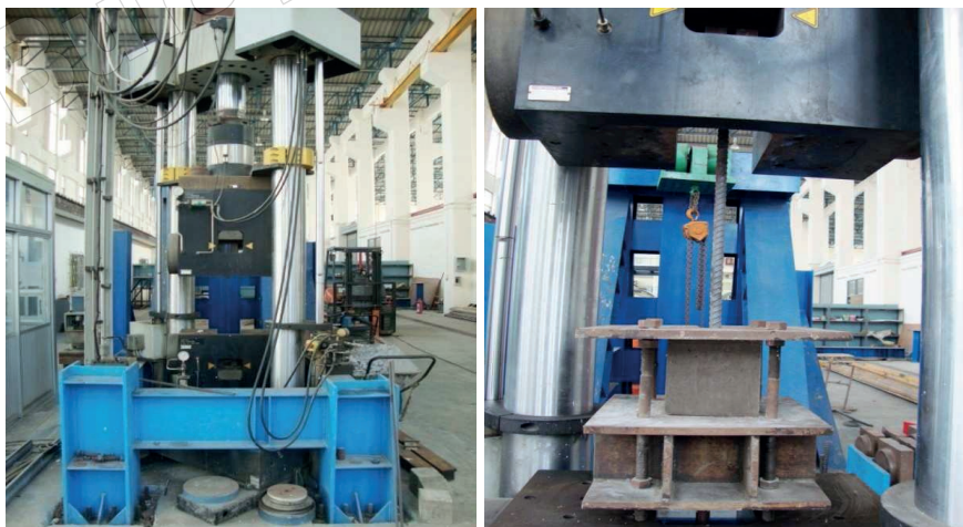
(ข) การทดสอบกำลังยึดเหนี่ยวของจีโอพอลิเมอร์คอนกรีตโดยใช้เครื่องทดสอบ Universal Testing Machine ขนาด 150 ตัน
