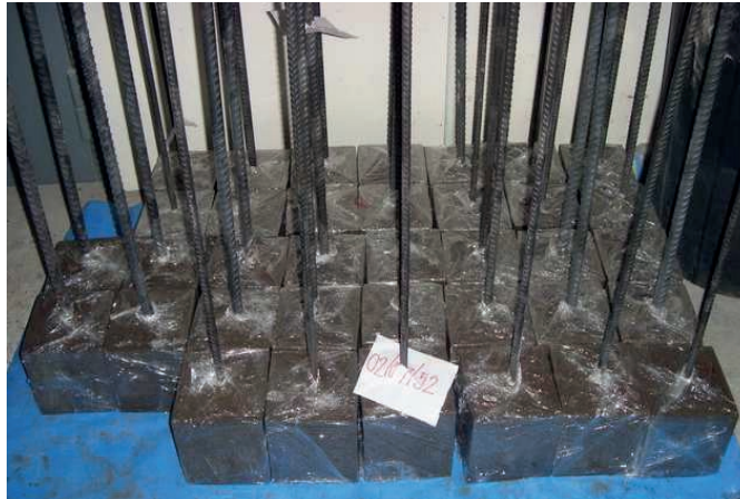
ภาพที่ 2 ตัวอย่างที่ใช้ทดสอบกำลังยึดเหนี่ยวของจีโอพอลิเมอร์คอนกรีต
