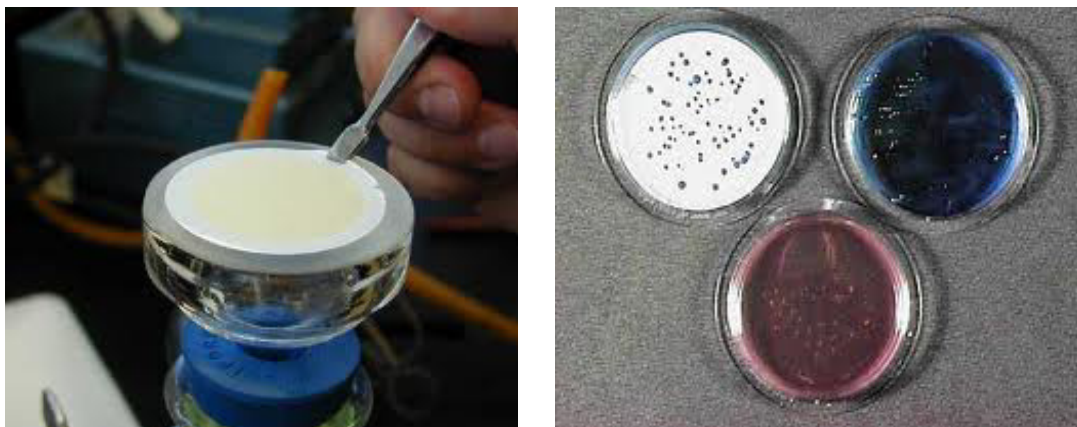
รูปที่ 2.15 ขั้นตอนการทำและเชื้อจุลินทรีย์หลังการทำ membrane filtration
