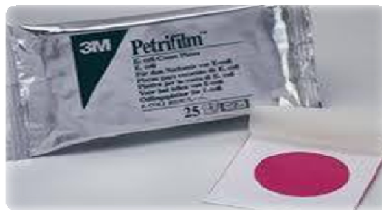
รูปที่ 1.3 ชุด Test kit สำหรับวิเคราะห์ยีสต์ โคโคไล โคลิฟอร์ม
