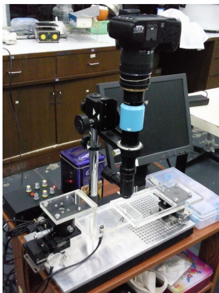
รูปที่ 3.2 High magnification stereomicroscopy
