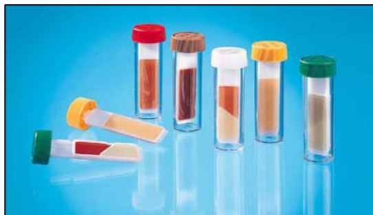
รูปที่ 1.2 ชุด Test kit สำหรับวิเคราะห์ยีสต์ รา
