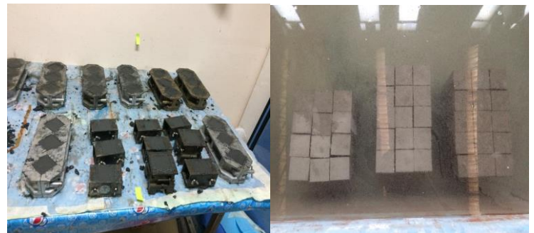
ภาพที่ 1 การเตรียมตัวอย่างมอร์ตาร์เพื่อทดสอบกำลังอัด
