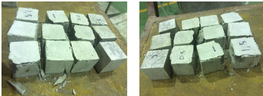
รูปที่ 3.6 ลักษณะการวิบัติของตัวอย่างมอร์ต้าร์
