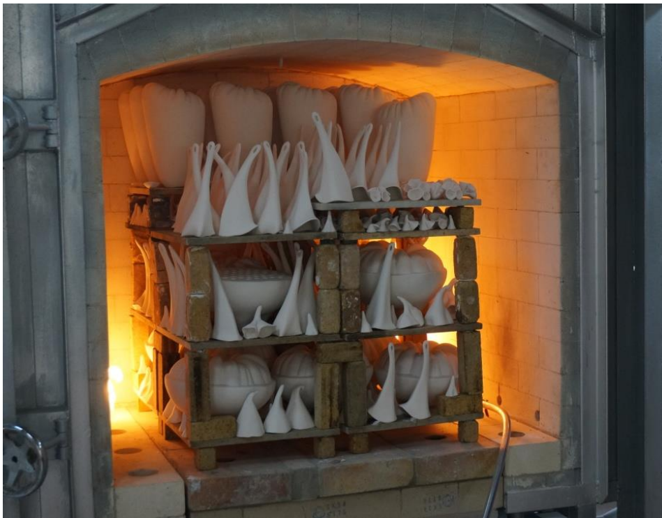
ภาพที่ ๓๕ กระบวนการเผาเคลือบที่อุณหภูมิ ๑๒๓๐ องศาเซลเซียส
