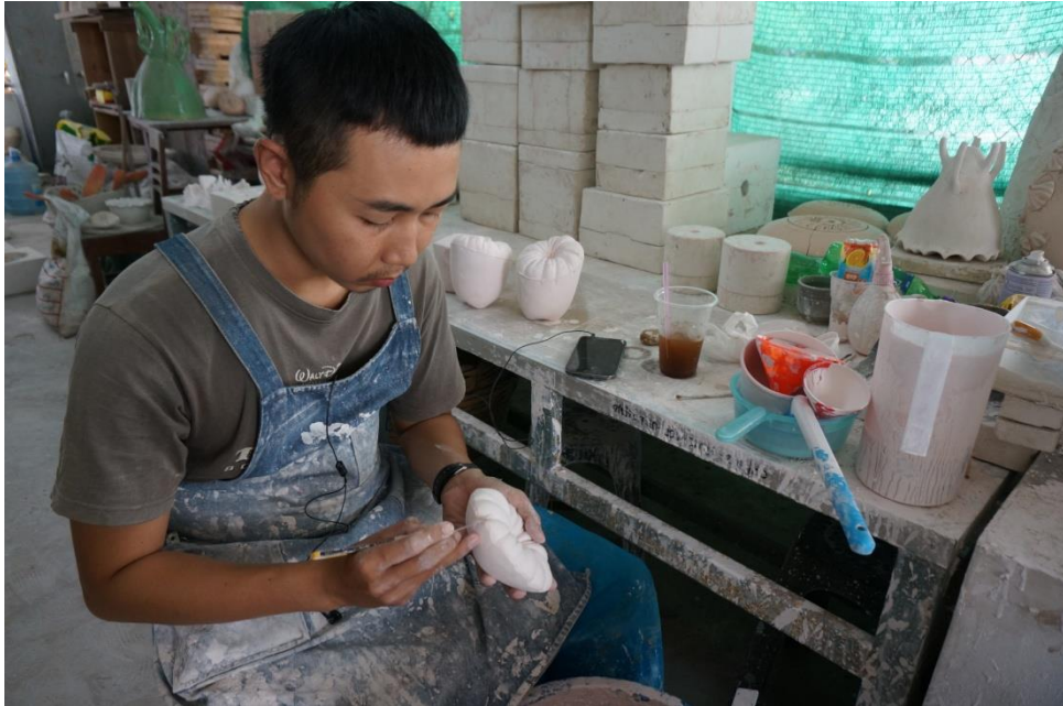
ภาพที่ ๓๒ กระบวนการเก็บแต่งตะเซ็บชิ้นงาน
