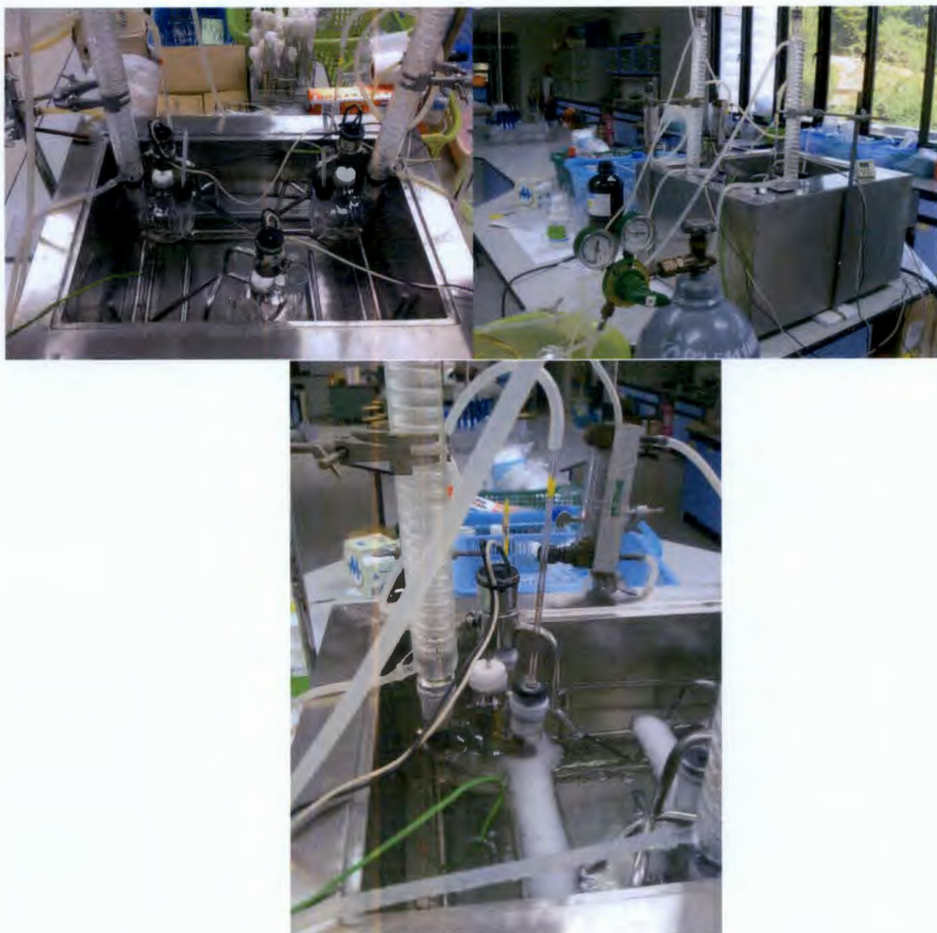
ภาพที่ 4-16 ภาพการต่อระบบสำหรับการสังเคราะห์พอลิเมอร์พอลิแล็กติกแอซิดโดยใช้เอนไซม์ Novozyme 435 เป็นตัวเร่งปฏิกิริยา
