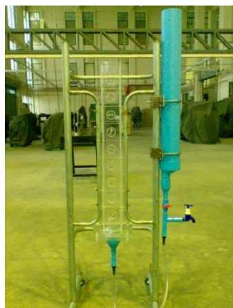
รูปที่ 3-5 อุปกรณ์ทดลองการไหลซึมผ่านแบบใช้กระบอกทรงสูง (One dimensional column)
