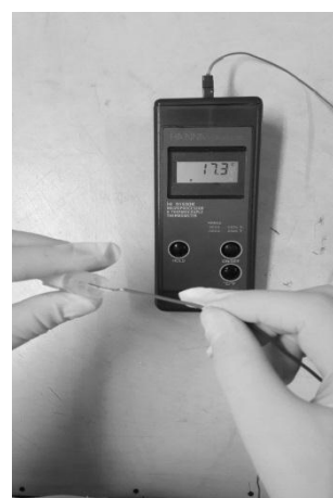
ภาพที่ 34 การวัดอุณหภูมิภายใน Cryotube 1.8 ml. หลังการละลายน้ำเชื้อที่ อุณหภูมิต่าง ๆ
