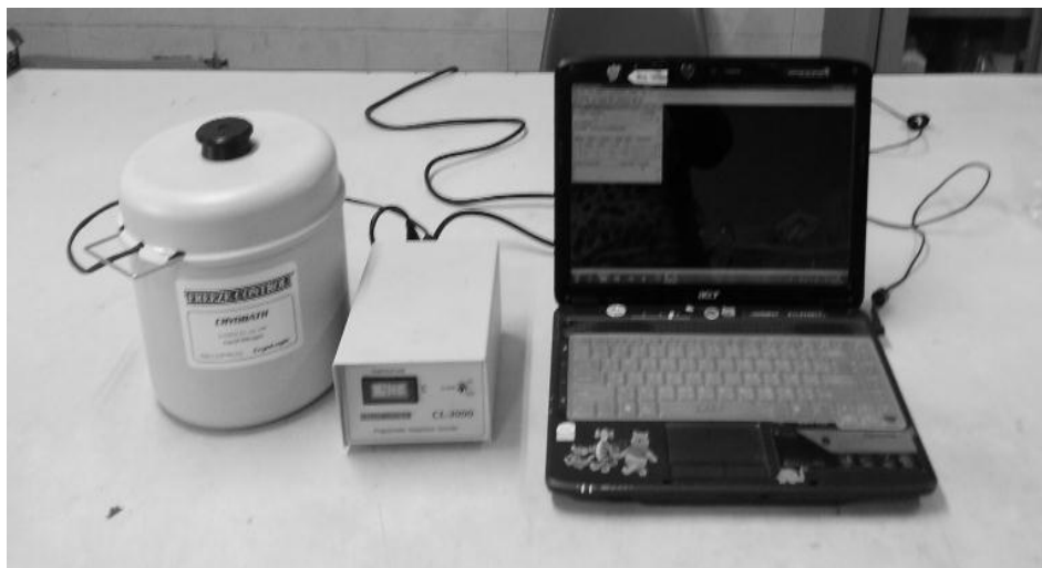
ภาพที่ 8 เครื่องลดอุณหภูมิอัตโนมัติ (Controlled – rate programmable freezer)
