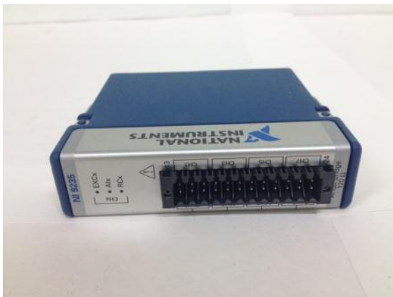
ภาพที่ 4-7 อุปกรณ์แปลงสัญญาณความเครียด (Strain gauge transformer module)
