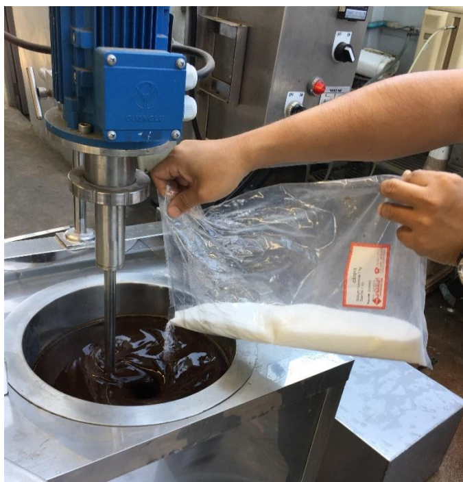
รูปที่ 4.9 เติมสารโซดาไฟ 2 กิโลกรัม โดยที่จะต้องค่อยเติมสารเข้าไปทีละน้อย อย่างต่อเนื่องเพื่อป้องกันความร้อนที่มากเกินไปจากการการละลายของโซดาไฟในน้ำ
