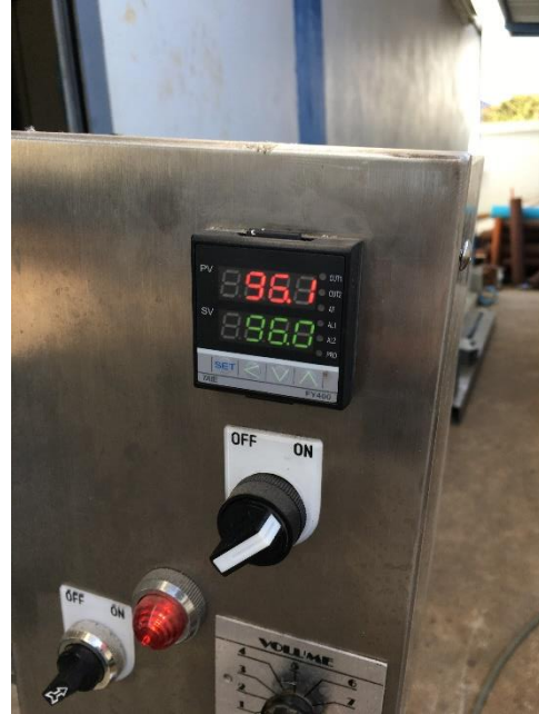
รูปที่ 4.12 เพิ่มความร้อนเป็น 96-100 องศาเซลเซียส เป็นเวลา 1 ชม. สารละลายจะเดือดและมีความเข้มข้นสูง โดยสภาวะนี้จะต้องเปิดความเร็วมอเตอร์ที่ระดับสูง เนื่องจากมีความหนืดมาก โดยหากเกิดฟองขึ้นในระบบต้องลดระดับความร้อนลงและเพิ่มความเร็วมอเตอร์ประกอบ
