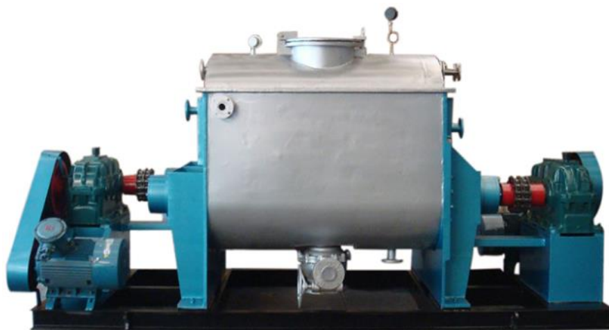
รูปที่ 2.10 เครื่องสกัดคาร์บอกซีเมทิลเซลลูโลส (CMC) รุ่น MM-50 ที่ผลิตโดยประเทศจีน [24]
