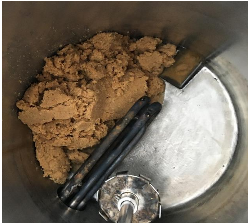
รูปที่ 4.22 นำเซลลูโลสที่ฟอกขาวแล้วใส่ลงในถังที่ 1 เติมน้ำเปล่า 3 ลิตร
