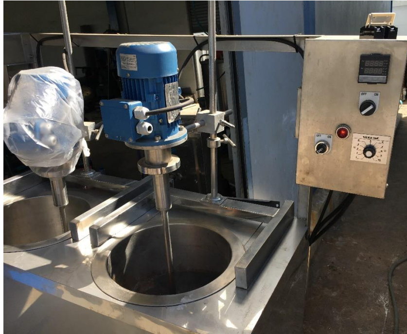
รูปที่ 4.5 ติดตั้งใบกวนในถังที่ 1 และเปิดเครื่อง
