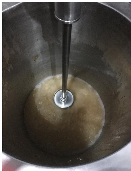
รูปที่ 4.27 ล้างผงคาร์บอกซีเมทิลเซลลูโลส (Carboxymethyl Cellulose (CMC)) ด้วยเมทานอล 2 รอบ โดยแต่ละรอบใช้เมทานอลปริมาตร 6 ลิตร
