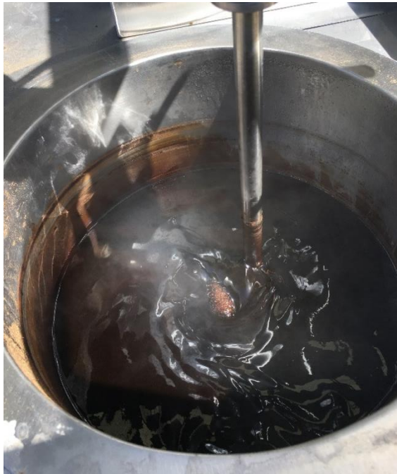
รูปที่ 4.11 เพิ่มความร้อนเป็น 90 องศาเซลเซียส เป็นเวลา 2 ชม. จนเดือด ในขั้นตอนนี้ระดับของเหลวที่อยู่ภายในถังที่ 1 ต้องลดระดับลงกึ่งหนึ่งตามรูป
