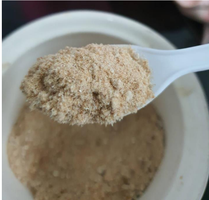
รูปที่ 4.30 คาร์บอกซีเมทิลเซลลูโลส (Carboxymethyl Cellulose (CMC)) หลังอบแห้งที่อุณหภูมิ 55 องศาเซลเซียส เป็นเวลา 12 ชั่วโมง
