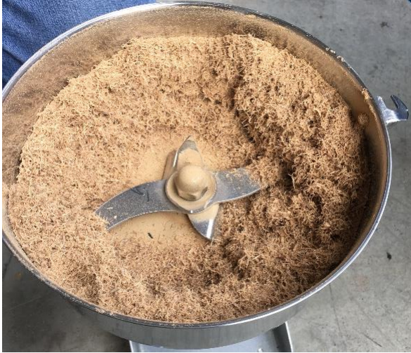
รูปที่ 4.3 เครื่องบดแห้งแบบละเอียด ให้ได้ขนาดอนุภาคที่ระดับ 50-300 Mesh
