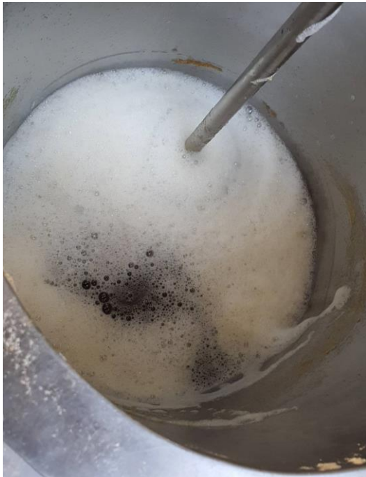
รูปที่ 4.27 ล้างผงคาร์บอกซีเมทิลเซลลูโลส (Carboxymethyl Cellulose (CMC)) ด้วยเมทานอล 2 รอบ โดยแต่ละรอบใช้เมทานอลปริมาตร 6 ลิตร
