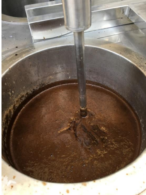
รูปที่ 4.12 เพิ่มความร้อนเป็น 96-100 องศาเซลเซียส เป็นเวลา 1 ชม. สารละลายจะเดือดและมีความเข้มข้นสูง โดยสภาวะนี้จะต้องเปิดความเร็วมอเตอร์ที่ระดับสูง เนื่องจากมีความหนืดมาก โดยหากเกิดฟองขึ้นในระบบต้องลดระดับความร้อนลงและเพิ่มความเร็วมอเตอร์ประกอบ
