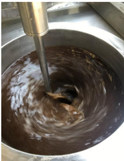
รูปที่ 4.16 ล้างด้วยน้ำเปล่าในถังที่ 2 พร้อมเปิดมอเตอร์ปั่นกวนสารละลาย
