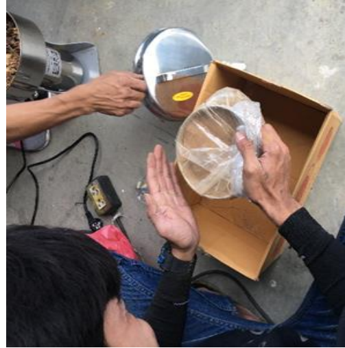
รูปที่ 4.3 เครื่องบดแห้งแบบละเอียด ให้ได้ขนาดอนุภาคที่ระดับ 50-300 Mesh
