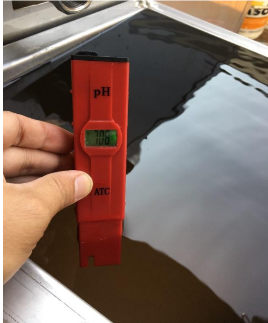
รูปที่ 4.17 วัดค่าความเป็นกรด-ด่างของน้ำที่ได้จากการล้างให้ได้อ่า ประมาณ 7
