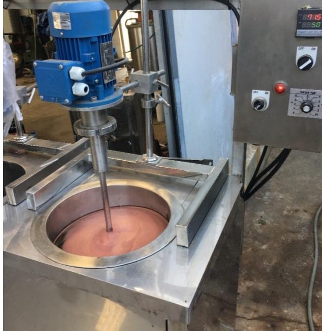
รูปที่ 4.10 เปิดฮีตเตอร์ทำความร้อน (Heater) ในถังที่ 1 จนกระทั่งเพิ่มความร้อนเป็น 90 องศาเซลเซียส เป็นเวลา 1 ชม.
