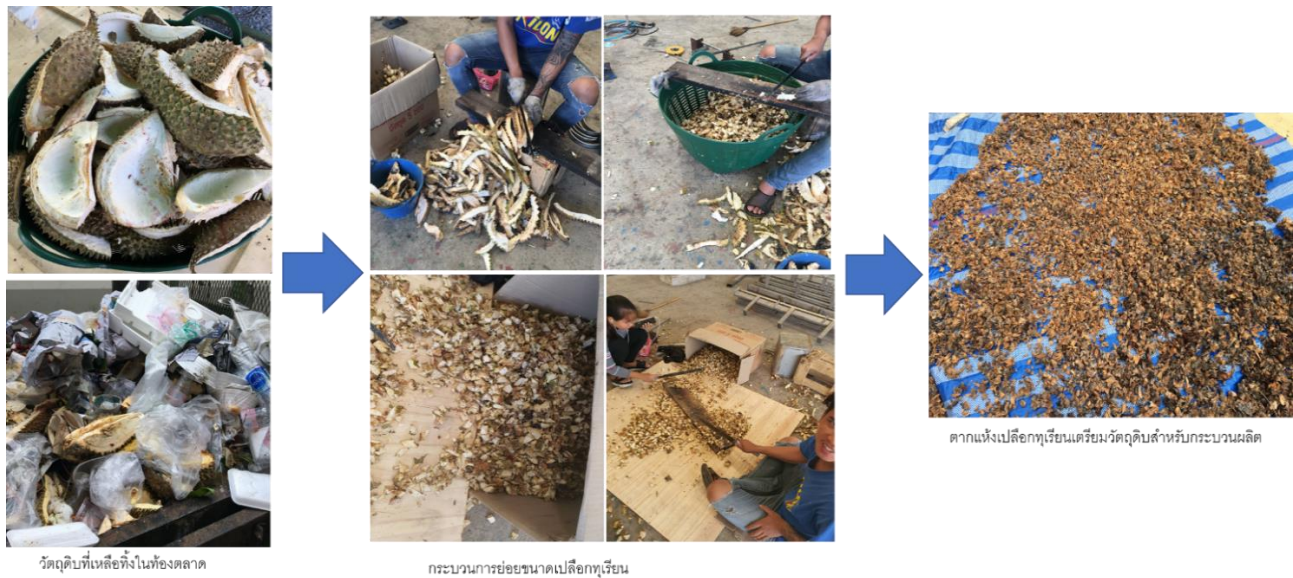
รูปที่ 4.2 ขั้นตอนในการเตรียมวัตถุดิบที่สกัดจากเปลือกทุเรียน
