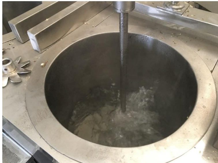
รูปที่ 4.6 เติมน้ำลงไปในถังที่ 1 จำนวน 20 ลิตร
