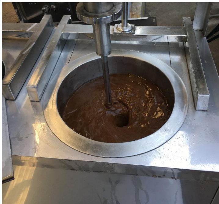
รูปที่ 4.8 เปิดการทำงานของมอเตอร์ที่ถังที่ 1 ในระดับความเร็วปานกลางจนของผสมเป็นเนื้อเดียวกัน
