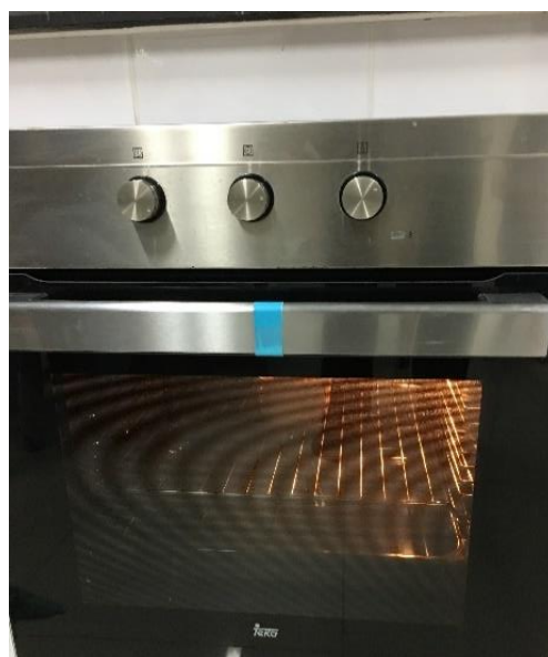
รูปที่ 4.29 อบสารผงคาร์บอกซีเมทิลเซลลูโลส (Carboxymethyl Cellulose (CMC)) ที่อุณหภูมิ 55 องศาเซลเซียส
