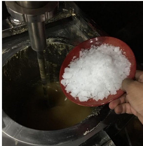
รูปที่ 4.24 เติมกรดโมโนคลอโรอะซิติก 360 กรัม และเปิด ฮีตเตอร์ทำความร้อน ที่ 55 องศาเซลเซียส กวนให้เข้ากันทิ้งไว้ 2 ชม.
