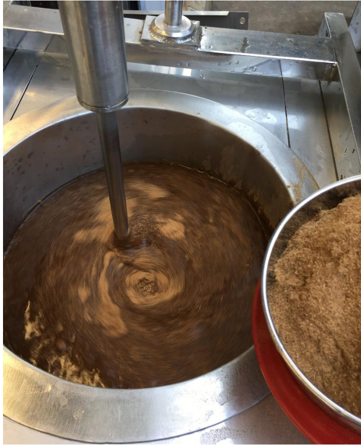
รูปที่ 4.7 ใส่เปลือกทุเรียนที่บดแห้งละเอียดจำนวน 1 กิโลกรัม พร้อมคั้นให้เข้ากันจนกระทั่งเข้าที่
