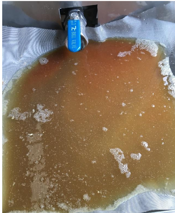
รูปที่ 4.26 การกรอง CMC โดยใช้ตะแกรง 80 Mesh
