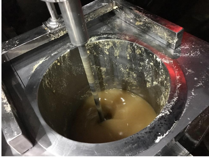
รูปที่ 4.25 เปิดฮีตเตอร์ทำความร้อน ที่ 55 องศาเซลเซียส กวนที่ความเร็วปานกลางให้เข้ากัน ทิ้งไว้ 2 ชม.
