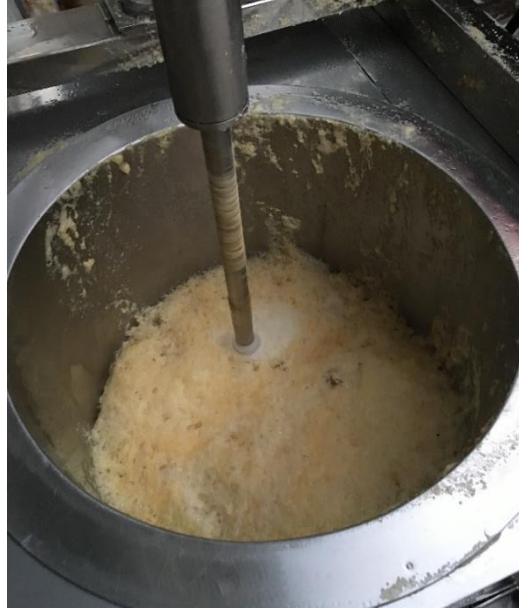
รูปที่ 4.23 เติมโซดาไฟ (NaOH) น้ำหนัก 0.9 กิโลกรัม กวนทิ้งไว้ 30 นาที
