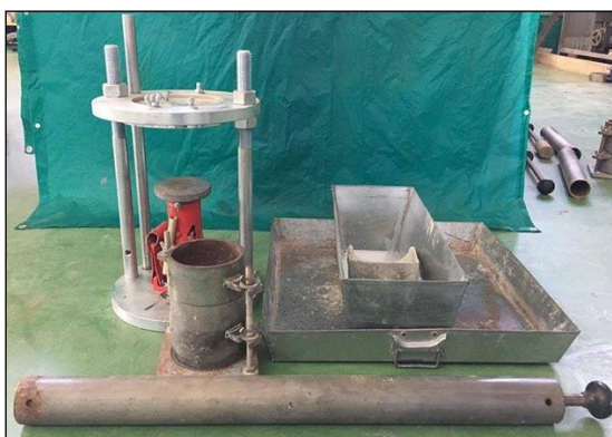
ภาพที่ 3.1 อุปกรณ์ที่ใช้ในการทดสอบการบดอัดดินแบบมาตรฐาน
