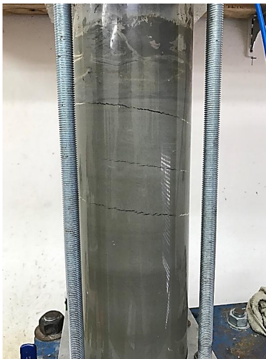
รูปที่ 4.4 ลักษณะรอบแตกร้าวเมื่อดินเหลวยังมีอากาศอยู่ในมวลดิน
