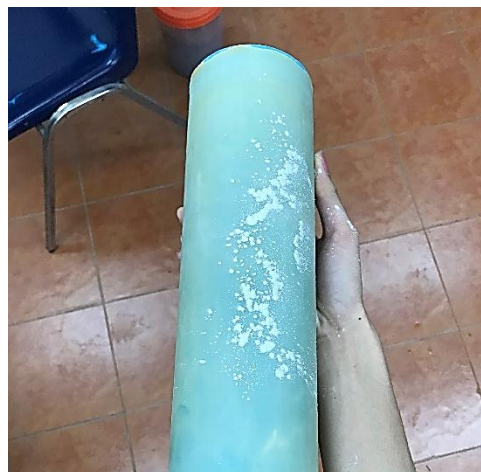
รูปที่ 4.7 การโรยแป้งก่อนแกะถุงยาง
