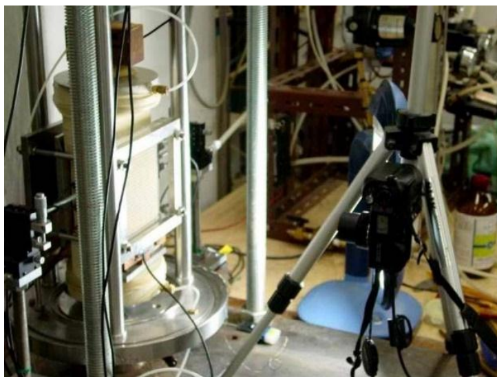
รูปที่ 2.14 ตัวอย่างดินและอุปกรณ์ทั้งหมดพร้อมทำการทดสอบ (Kongkitkul, 2004)
