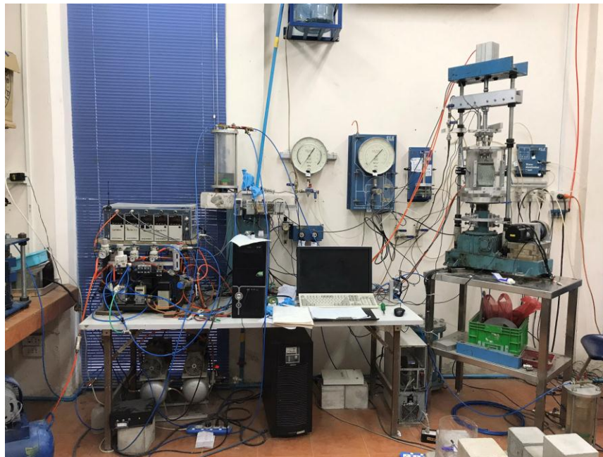
รูปที่ 3.4 เครื่องทดสอบแรงเฉือนในสภาวะแวดล้อมความเครียดในระนาบ
