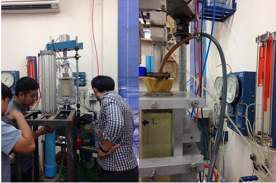
รูปที่ 4.31 การดันดินเหลวเข้าสู่เครื่องทดสอบจมน้ำดินและน้ำส่วนเกินออกมา
