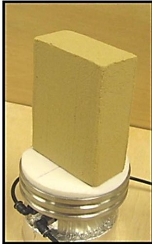
รูปที่ 2.22 ตัวอย่างดินหลังการตัดแต่งมีขนาด 90 x 60 x 30 มม. (Jose et al., 2012)
