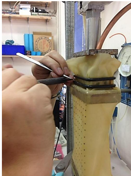
รูปที่ 4.17 การเจาะรูถุงยางด้านบน
