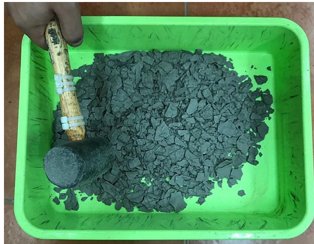
รูปที่ 4.3 การทุบดินให้มีขนาดเล็กกลงด้วยค้อนยาง
