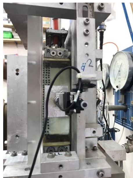
รูปที่ 4.37 การติดตั้ง gab sensor ที่ด้านข้างของตัวอย่างดิน
