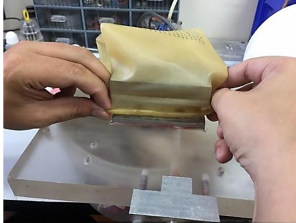
รูปที่ 4.9 การสวมถุงยางเข้ากับแท่นกดด้านล่าง
