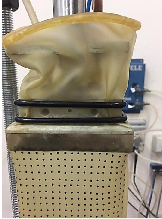
รูปที่ 4.16 การสวมโอริง (O-Ring) เข้ากับแท่นด้านบน
