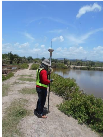
รังวัดพิกัดดาวเทียม GPS แบบ RTK (Rover) ในการเก็บรายละเอียดลักษณะภูมิประเทศ
