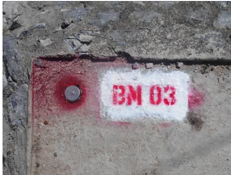
BM 03 หมุดสแตนเลสฝังบริเวณถนนทางออกไปเตาเผาขยะของหมู่บ้าน N = 722,437.249 ม. , E = 617,086.578 ม. , EL = 1.842 ม. (รทก.)
