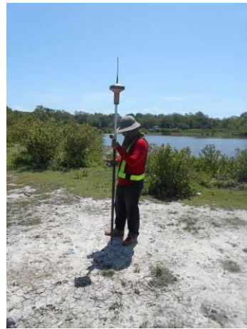
รังวัดพิกัดดาวเทียม GPS แบบ RTK (Rover) ในการเก็บรายละเอียดลักษณะภูมิประเทศ
