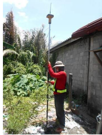
รังวัดพิกัดดาวเทียม GPS แบบ RTK (Rover) ในการเก็บรายละเอียดลักษณะภูมิประเทศ
