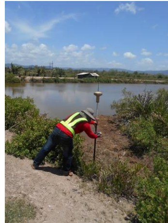
รังวัดพิกัดดาวเทียม GPS แบบ RTK (Rover) ในการเก็บรายละเอียดลักษณะภูมิประเทศ
