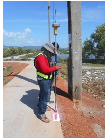
BM 04 หมุดสแตนเลสฝังบริเวณถนนหน้าเตาเผาขยะของหมู่บ้าน N = 722,375.717 ม. , E = 617,326.416 ม. , EL = 2.413 ม. (รทก.)
