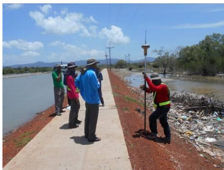
รังวัดพิกัดดาวเทียม GPS แบบ RTK (Rover) ในการเก็บรายละเอียดลักษณะภูมิประเทศ
