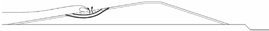
(ก) การกัดเซาะคันดิน บริเวณลาดด้านเหนือน้ำ
