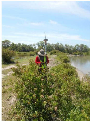
รังวัดพิกัดดาวเทียม GPS แบบ RTK (Rover) ในการเก็บรายละเอียดลักษณะภูมิประเทศ
