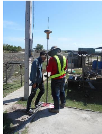
BM 03 หมุดสแตนเลสฝังบริเวณถนนทางออกไปเตาเผาขยะของหมู่บ้าน N = 722,437.249 ม. , E = 617,086.578 ม. , EL = 1.842 ม. (รทก.)
