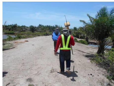
รังวัดพิกัดดาวเทียม GPS แบบ RTK (Rover) ในการเก็บรายละเอียดลักษณะภูมิประเทศ
