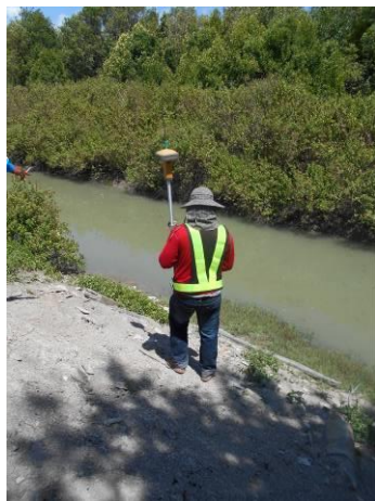
รังวัดพิกัดดาวเทียม GPS แบบ RTK (Rover) ในการเก็บรายละเอียดลักษณะภูมิประเทศ
