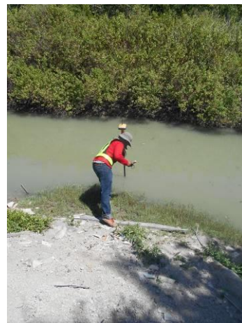
รังวัดพิกัดดาวเทียม GPS แบบ RTK (Rover) ในการเก็บรายละเอียดลักษณะภูมิประเทศ
