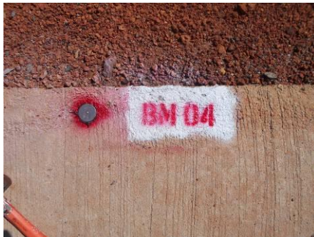
BM 04 หมุดสแตนเลสฝังบริเวณถนนหน้าเตาเผาขยะของหมู่บ้าน N = 722,375.717 ม. , E = 617,326.416 ม. , EL = 2.413 ม. (รทก.)
