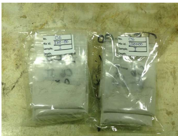
รูปที่ 3.35 ตัวอย่างผงซีเมนต์ที่ได้จากการเจาะในแต่ละชั้น
