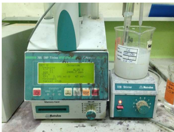
รูปที่ 3.38 การไตเตรทหาปริมาณคลอไรด์
