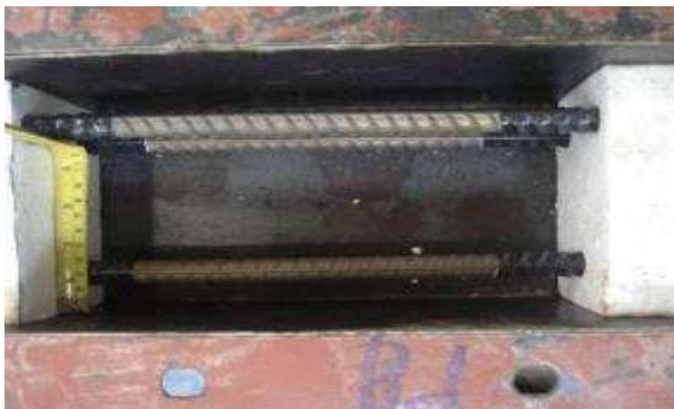
รูปที่ 3.6 แบบหล่อตัวอย่างทดสอบปริมาณคลอไรด์วิกฤตของคอนกรีต และระยะการเกิดสนิมในเหล็กเสริม
