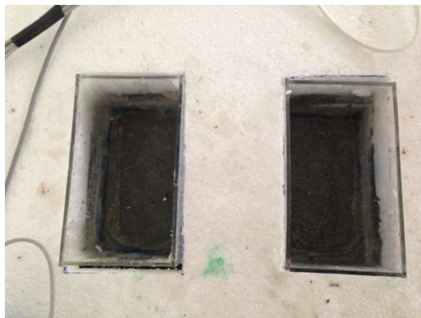
รูปที่ 3.23 เจาะช่องด้านบนกล่องสำหรับวัดค่าศักย์ไฟฟ้าครึ่งเซลล์
