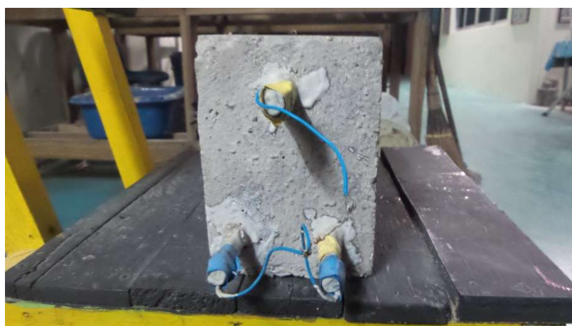
รูปที่ 3.30 ตัวอย่างที่ติดตั้งตัวต้านทาน 100 โอห์ม
