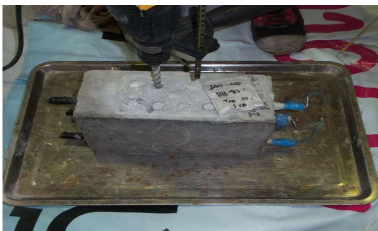
รูปที่ 3.33 การเก็บตัวอย่างคอนกรีตเพื่อนำไปทดสอบหาปริมาณคลอไรด์ที่ระยะ ความลึกต่างๆ
