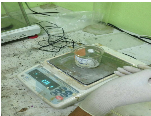
รูปที่ 3.36 การชั่งตัวอย่างผงคอนกรีต
