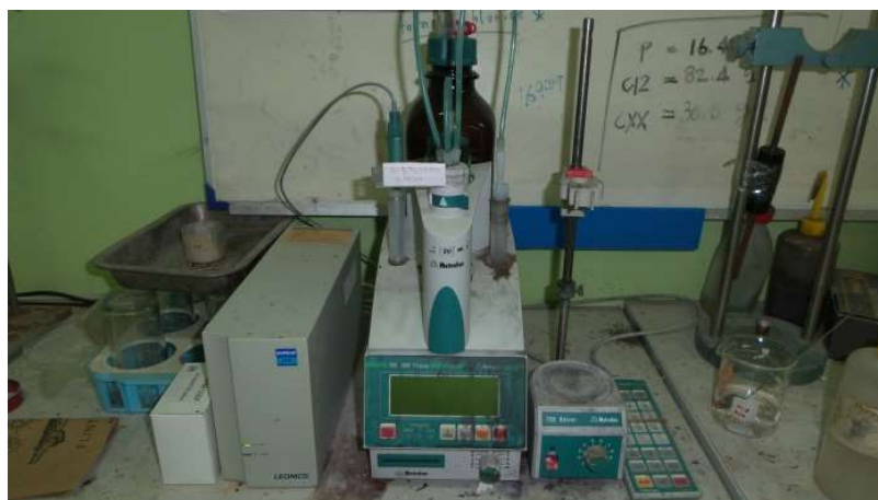
รูปที่ 3.11 เครื่อง Auto titration รุ่น 785 DMP TitrinoMetrohm
