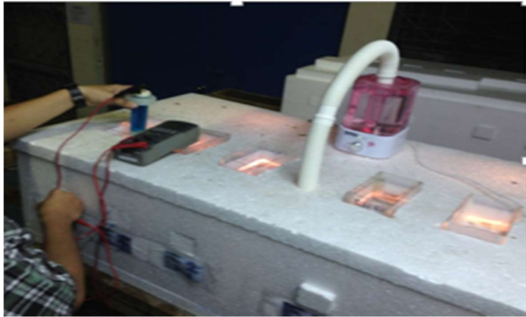
รูปที่ 3.31 การวัดค่าศักย์ไฟฟ้าครึ่งเซลล์ในก้อนตัวอย่างที่ควบคุม
