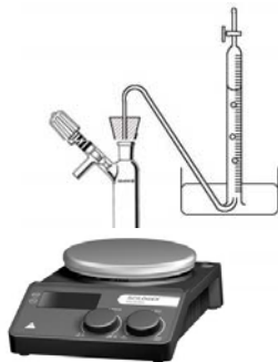
ภาพที่ 1 แบบจำลองการวัดปริมาตรแก๊สที่เกิดขึ้นจากปฏิกิริยาการสลายตัวของกรดฟอร์มิคโดยวิธีการแทนที่น้ำ
