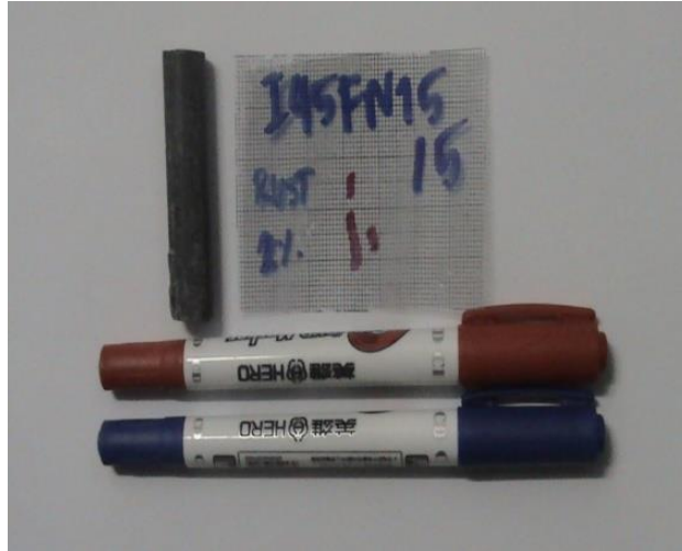
รูปที่ 3.9 การวัดพื้นที่ผิวของเหล็กที่เกิดสนิมด้วยแผ่นกราฟพลาสติกใส
