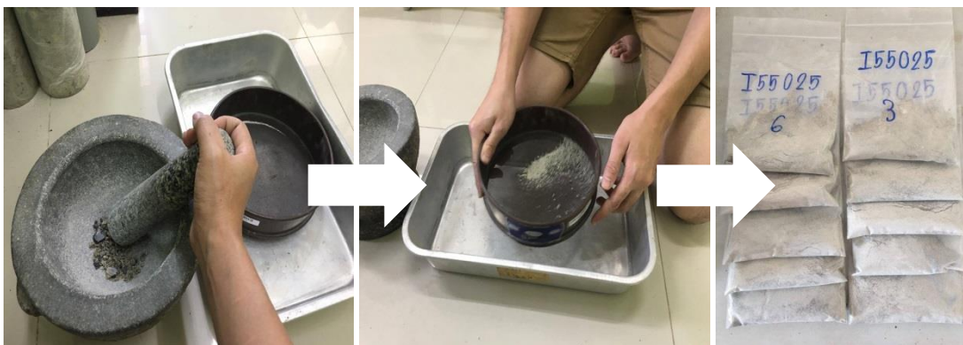
รูปที่ 3.8 การเตรียมตัวอย่างคอนกรีตเพื่อทดสอบการแทรกซึมคลอไรด์
