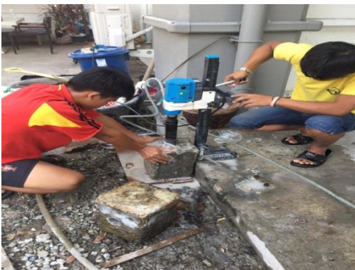
(ก) การเจาะตัวอย่างคอนกรีต
