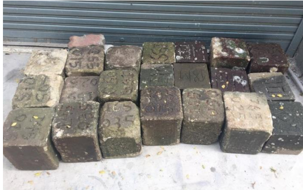
รูปที่ 3.4 ตัวอย่างจีโอโพลิเมอร์คอนกรีตจากถ้ำถ่านหิน หลังแช่ในน้ำทะเลในสภาพเปียกสลับแห้ง
