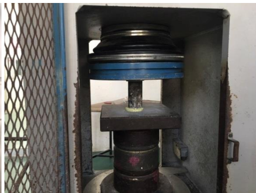
(ค) การเคลบตัวอย่างคอนกรีตโดยใช้กัมมะถัน (ง) การทดสอบกำลังอัดด้วยเครื่องทดสอบ UTM
