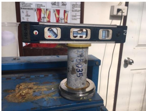
(ค) การเคลบตัวอย่างคอนกรีตโดยใช้กัมมะถัน (ง) การทดสอบกำลังอัดด้วยเครื่องทดสอบ UTM
