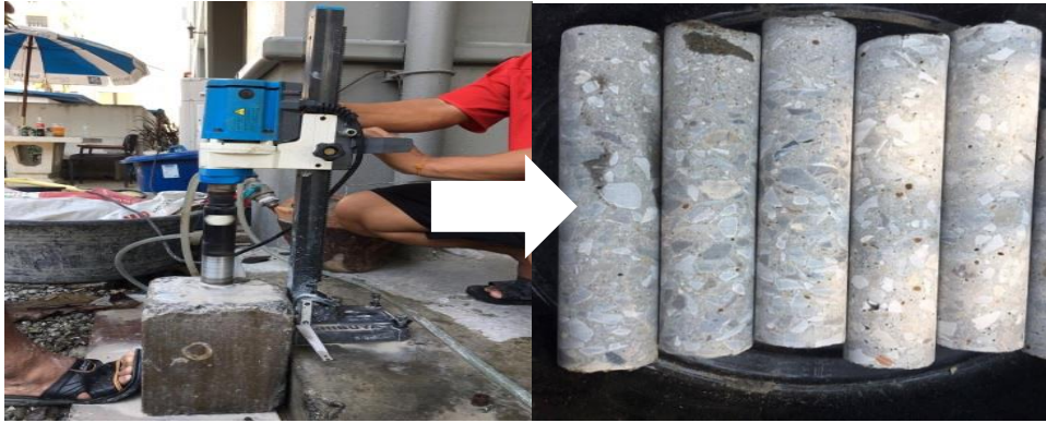
รูปที่ 3.6 การเจาะตัวอย่างคอนกรีตให้เป็นตัวอย่างทรงกระบอกขนาดเส้นผ่านศูนย์กลาง 50 มม.
