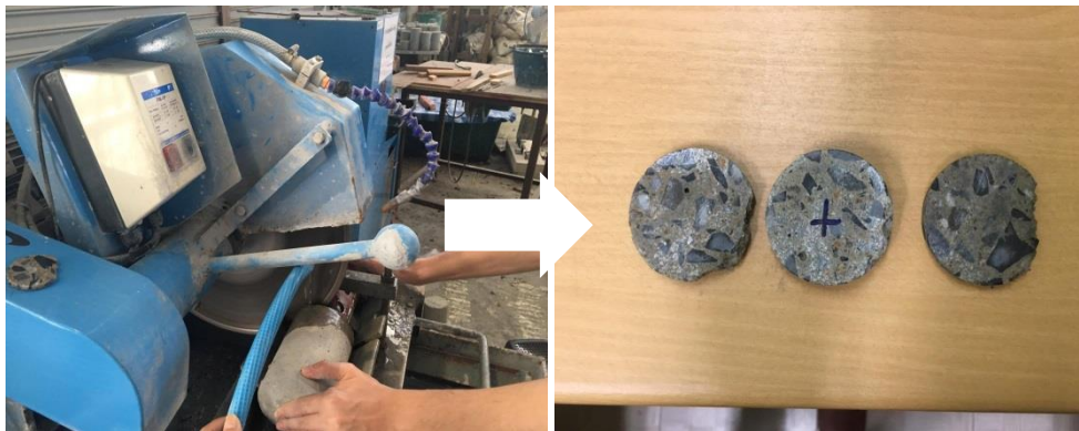
รูปที่ 3.7 การตัดตัวอย่างทรงกระบอกเป็นชั้นๆ ละ 10 มม.
