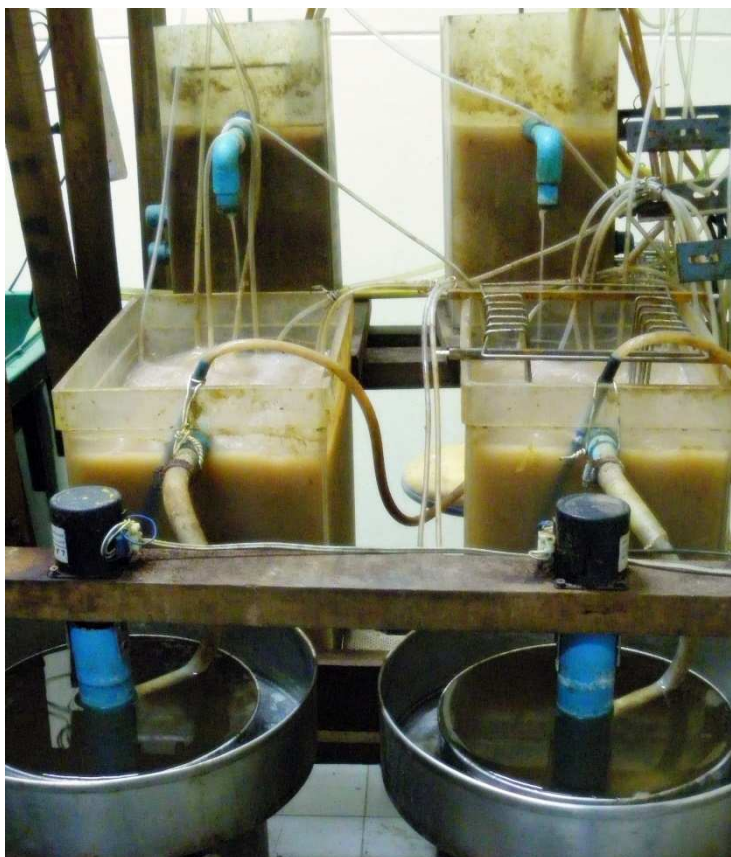
ภาพที่ 4 ระบบบำบัดน้ำเสียจำลอง A/O หรือ MLE ของระบบบำบัดน้ำเสีย IFAS 1 และ IFAS 2
