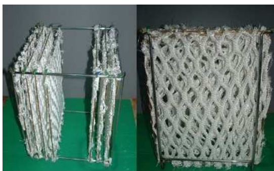
ภาพที่ 8 ตัวกลาง Bioweb ® ที่ใช้ในระบบบำบัดน้ำเสีย IFAS 1 และ IFAS 2
