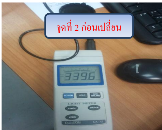
ภาพที่ 4-50 เปรียบเทียบค่าความสว่าง ก่อน-หลังการเปลี่ยนหลอดไฟ จุดที่ 2
