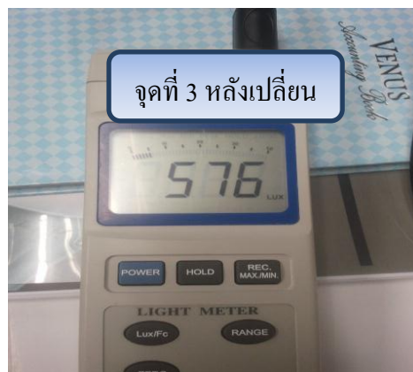
ภาพที่ 4-51 เปรียบเทียบค่าความสว่าง ก่อน-หลังการเปลี่ยนหลอดไฟ จุดที่ 3
