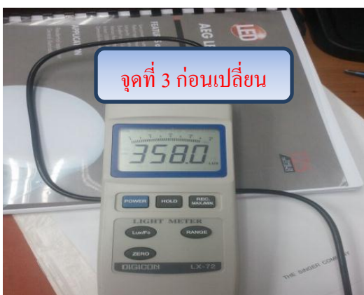
ภาพที่ 4-51 เปรียบเทียบค่าความสว่าง ก่อน-หลังการเปลี่ยนหลอดไฟ จุดที่ 3
